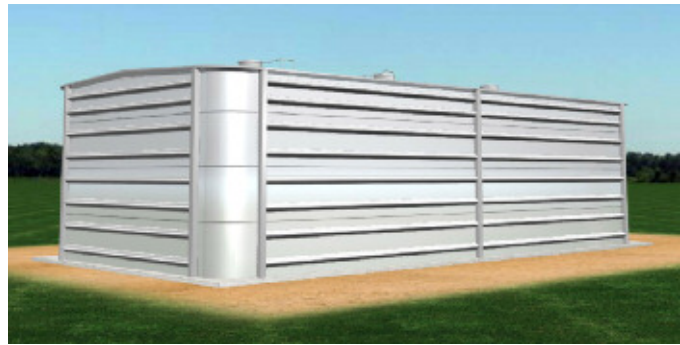
図-30 新設接合井矩形タンク案
