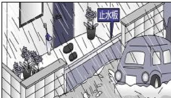
図. 止水板のイメージ図
