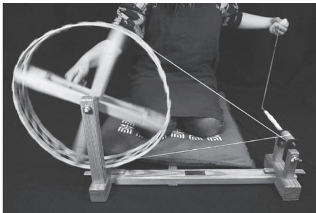
糸車を使って綿から糸を紡ぎます。綿の繊維を引き出し撚りをかけ、巻き取るという糸を紡ぐ工程がよくわかります。
