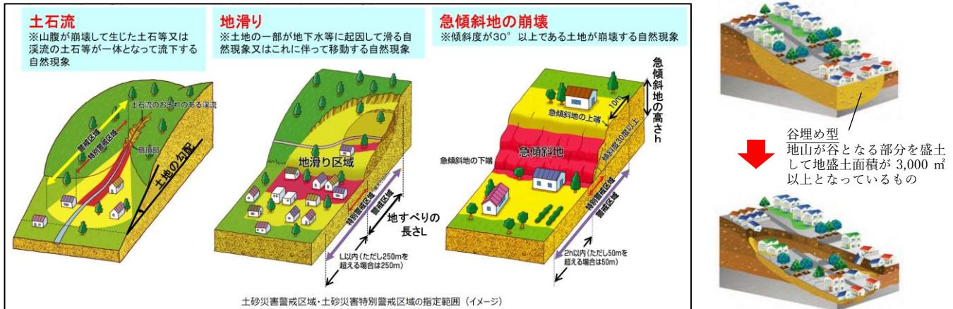
谷埋め型大規模盛土造成地で発生する滑動崩落イメージ（大規模盛土造成地の滑動崩落 対策推進ガイドライン／H27.5 国交省）
