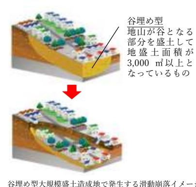
谷埋め型大規模盛土造成地で発生する滑動崩落イメージ
