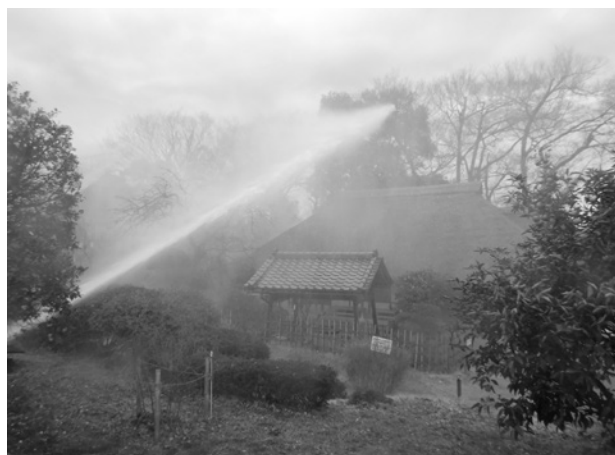
放水銃の放水試験の様子
