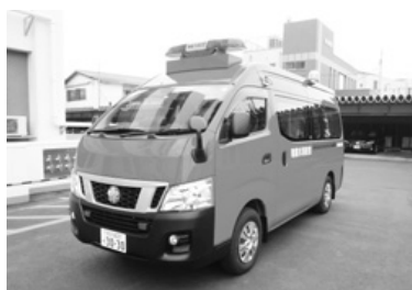
救助資機材・小型動力ポンプ搭載多機能車
