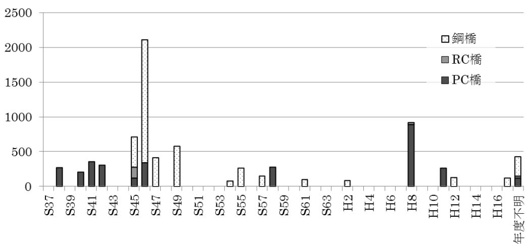
図 2-26：橋梁の建設年別構造別面積（単位：m<sup>2</sup>）
