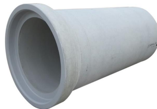
ヒューム管（コンクリート製） （正式名称：遠心力鉄筋コンクリート管） 管の直径が60cmを超える場合に用いられてい ます。ヒュームは発明者の名前が由来です。
