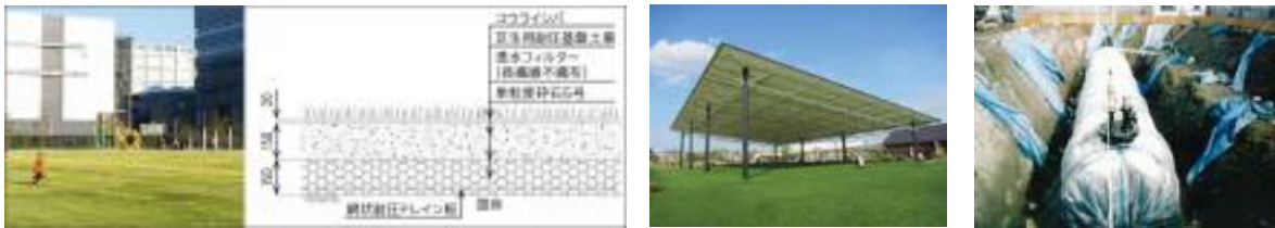
重量車両対応芝生広場（さいたま新都心公園） 屋根付き広場（安満遺跡公園／大阪府高槻市） 耐震性貯水槽
