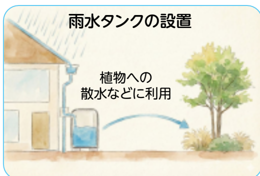
雨水貯留槽の設置
