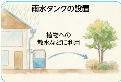
雨水貯留槽の設置
